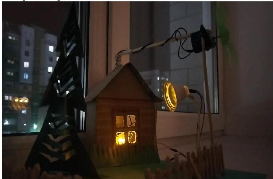
Вывод: собранный макет работает, светодиоды светятся, флюгер поворачивает ротор, тем самым ловя меняющиеся воздушные потоки. Но я также пришел к выводу, что в домашних условиях невозможно увидеть всех нюансов использования ветрогенератора. Вентилятор дает постоянный поток воздуха, что не соответствует реальным уличным условиям.
